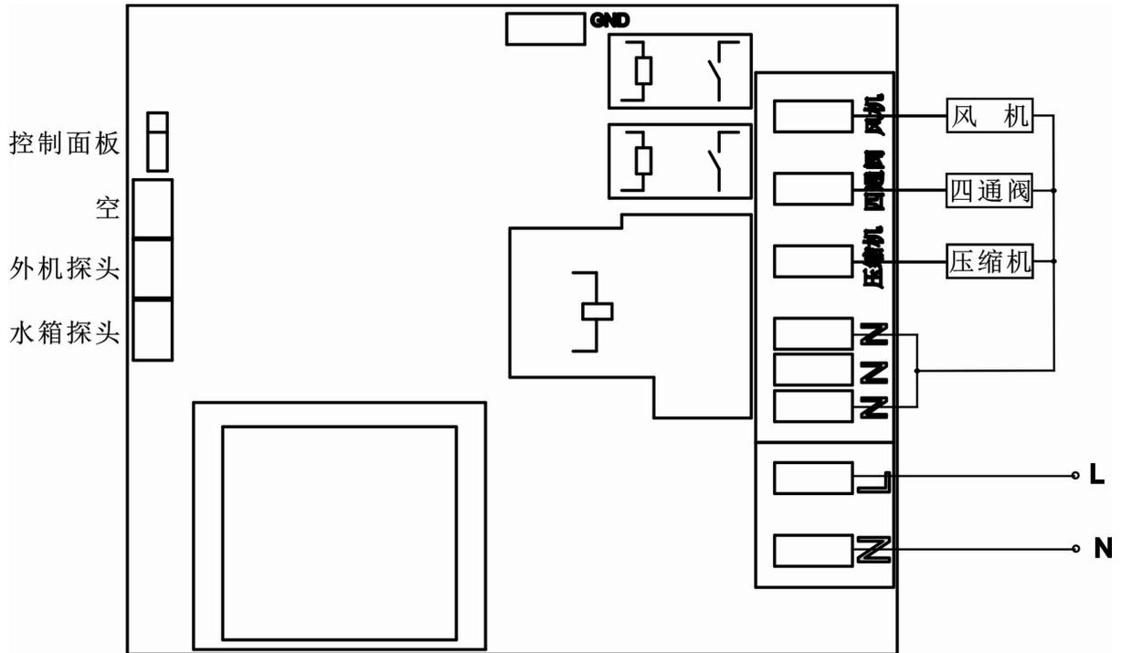
\*注： 外机板上的四个安装孔，其中接线端子一侧的两个，因靠近强电部分，请与外机金属部分绝缘，另外两个安装孔是外机板的地线，可以直接和外机金属部分相连，并且强烈建议和外机接地金属部分进行可靠的电气连接（例如使用金属垫脚），可以提高抗干扰能力。
