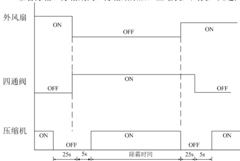
当制热过程执行除霜指令时，压缩机停止运行，25 秒后四通阀换向同时风机停止运行，5 秒后压缩机开启。当除霜过程中执行退出指令时，压缩机停止运行同时风机开启，25 秒后四通阀换向，5 秒后压缩机开启。
