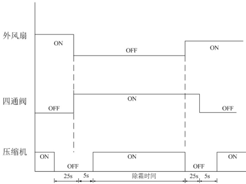
当制热过程执行除霜指令时，压缩机停止运行，25秒后四通阀换向同时风机停止运行，5秒后压缩机开启。当除霜过程中执行退出指令时，压缩机停止运行同时风机开启，25秒后四通阀换向，5秒后压缩机开启
