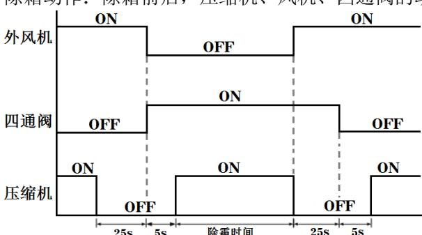
当制热过程执行除霜指令时，压缩机停止运行，**25**秒后四通阀换向同时风机停止运行，**5**秒后压缩机开启。当除霜过程中执行退出指令时，压缩机停止运行同时风机开启，**25**秒后四通阀换向，**5**秒后压缩机开启。
