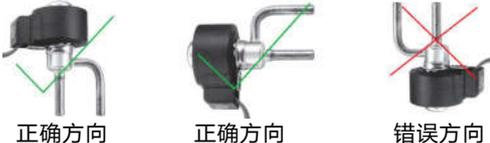
注意：在任何情况下都不能将膨胀阀倒置安装，不能将膨胀阀定子线圈朝下！
