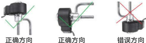
注意：在任何情况下都不能将膨胀阀倒置安装，不能将膨胀阀定子线圈朝下！
